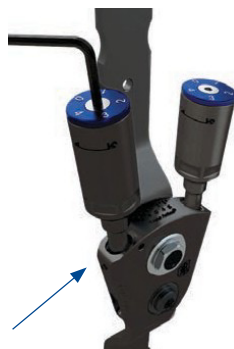
Figur 3. Løsne ROM-skruen med 2 mm justeringsnøkkel og nullstill ROM-innstillingen ved å dreie den blå ROM-skiven. ROM-låseskruen fungerer som referanse for denne justeringen (figur 3a og 3b).
