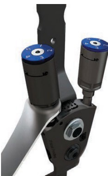
Figur 2. Juster ROM-innstillingen til 0° ved å vri boosterens helt med klokken med justeringsnøkkelen.
